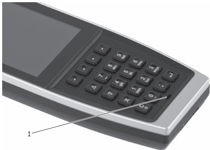
Abb. 30: Kerbe im Tastenführungsgitter
